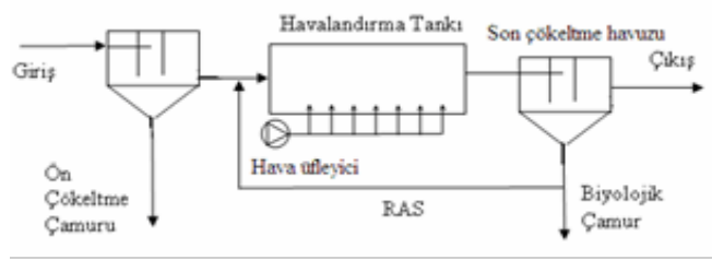
Şekil 1: Atıksu Arıtma Tesisi İş Akım Şeması
